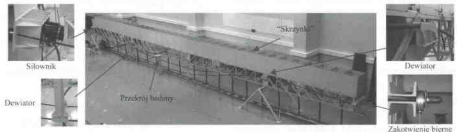
Rys. 5. Model z symulatorem ładunku („skrzynki” mają być napełnione wodą) [8]
