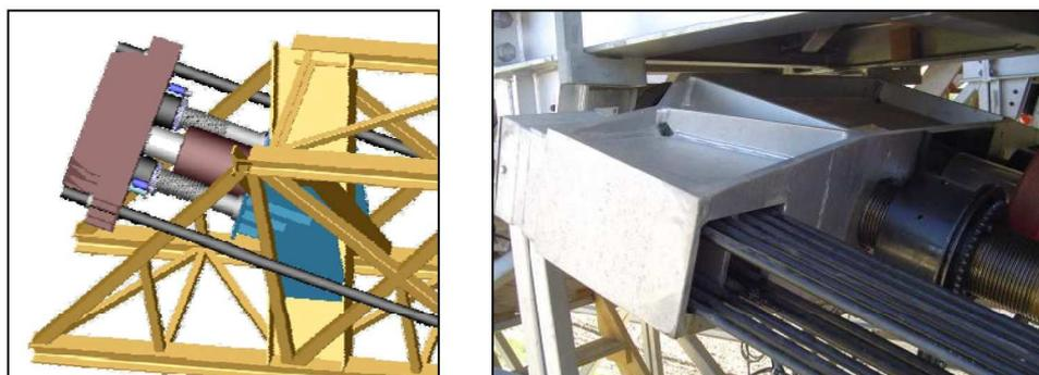
Figura 7 – Ancoragem orgânica e fusos de segurança
