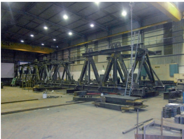
↑ Fig.4.3 Módulos de viga em fase de fabrico.
